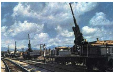
Bild 2: 10,5 cm Flakbatterie auf Eisenbahnwaggon (<http://www.ww2technik.de/Bilderchen/gerflak/schwer/>)
